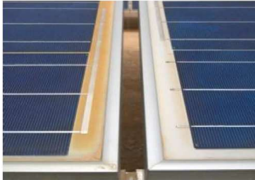
Degradación del laminado
