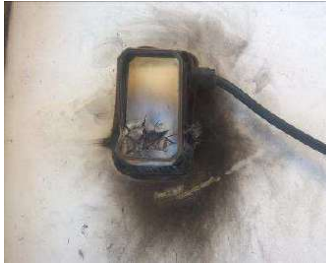
Caja de conexión quemada por conexión interna defectuosa
