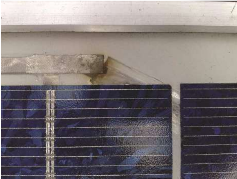
Rotura de interconexión interna
